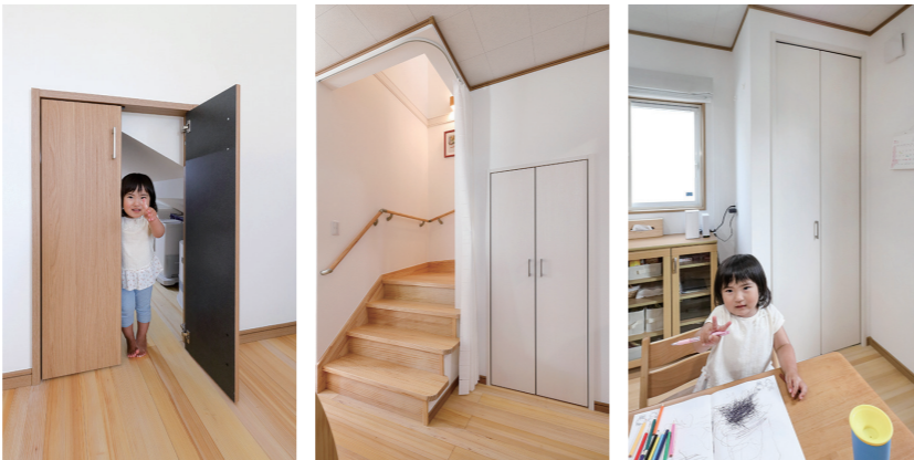
寝室から地続きで出入りできる便利な小屋裏収納。小窓と換気扇を設け子どもの秘密基地にも コの字型の折り返し階段を設けたことで、階段下を有効活用して大容量の収納を確保できた 生活感が出ない扉付きのダイニング収納は天井高まであり子どものモノもたっぷり収納できる
