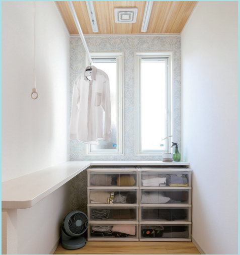
脱衣所とは別に設けたランドリールーム。洗濯物にアイロンをかけて畳む作業場所としてカウンターを造作。床と天井に調湿・消臭作用があるモミの木を採用
